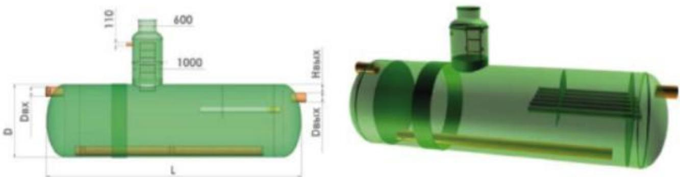
Сорбционный блок представляет собой емкость, которая заполняется композитным материалом – гидрофобным сорбентом. Этот материал производится на основе природных алюмосиликатов, и загружается в верхнюю часть емкости. Сорбент обеспечивает глубокую доочистку сточных вод от нефтепродуктов – до 0,05 мг/л, по взвешенным веществам до 3 мг/л. Такие параметры обеспечивают возможность сброса стоков в водоемы рыбохозяйственного назначения.
