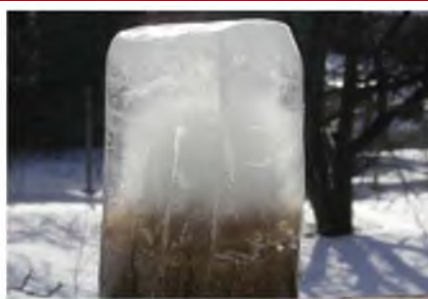
Проба воды из аэротенка. Это наглядный результат работы наших станций. В нижней части виден осевший активный ил. В верхней части — очищенная вода.
